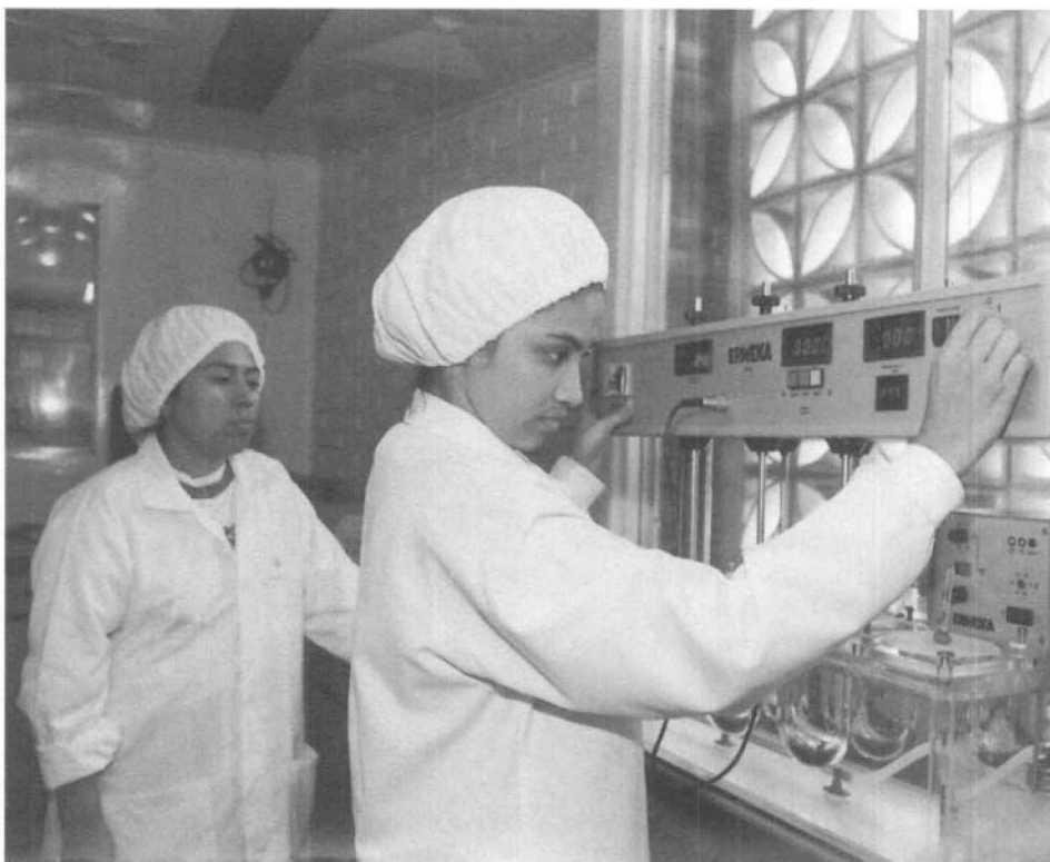
Fig. 5. Dissolution-Tester in der Abteilung für Qualitätskontrolle. Bestimmung der Auflösungskinetik in Tabletten und Kapseln von \beta -Lactam-Antibiotika.
