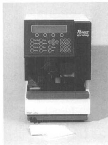
Gerät kann sowohl stand alone als auch in einem kompletten Mikro HPLC-System Ultimate™ betrieben werden.
