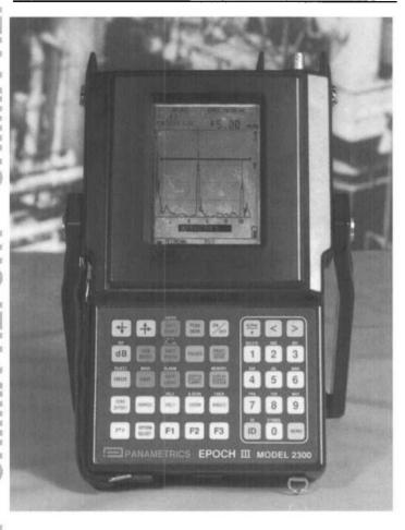
Zur Schweissnaht- und Haftungsprüfung, Wanddickenüberwachung oder auch zur Riss- und Porositätsprüfung, leistet das Prüfgerät EPOCH III mit AVG-Software (nach DIN 54127) wertvolle Dienste. Damit lassen sich AVG Kurven besonders einfach selbst erstellen. Die Software arbeitet interaktiv und zuverlässig zwischen einem PC und dem Ultraschall-Prüfgerät.
