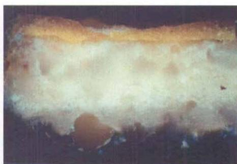
Fig. 8. Coupe stratigraphique (CPL01028.5) d'un échantillon prélevé sur la robe de l'Enfant Jésus. Couche d'orpiment reposant sur une préparation à base de gypse. Grandeur réelle 0.72 mm.
