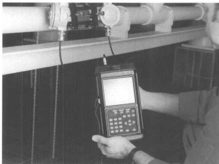
Das Display ist mit 240 x 200 Pixel im neuen Gerät grafikfähig. Auf der LCD-Anzeige sieht der Bediener Messwerte, Einstelldaten oder Schallsignale, maximal bis zu 4 Anzeigen gleichzeitig. Damit ist eine sichere Beurteilung des angezeigten Messwerts möglich. Eine Fehlerzeile im Display informiert über den jeweiligen Status der automatischen Selbstüberprüfung.
