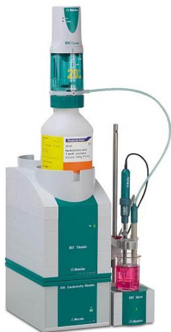
Das 856 Conductivity Module ist das neue Leitfähigkeitsmessgerät von Metrohm. Es kann mit Leitfähigkeitsmesszellen neuester Technologie, den Fünf-Ring-Leitfähigkeitsmesszellen, messen. Bei diesen wird ohne Platinierung der Zellen ein hoher Linearitätsbereich erreicht (wartungsfrei!). Die Fünf-Ring-Messzellen liefern zudem genaue Messwerte unabhängig von der Eintauchtiefe.
