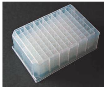
Diese extratiefe 2 ml Mikroplatte mit quadratischen Vertiefungen von Porvair Sciences Ltd. wurde bei Reinraumbedingungen aus ultrahochreinem Polypropylen hergestellt. Das macht die 96-Well-Platte zur ersten Wahl von Labors für die Lagerung, Fraktionierung oder Festphasenextraktion von hochreinen Verbindungen.
