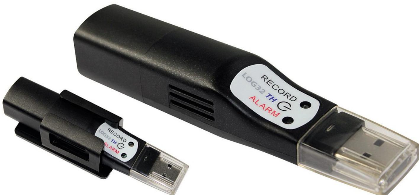
Mit dem LOG 32-TH erweitert die Dostmann electronic GmbH ihr Produktangebot von Datenloggern um ein besonders kompaktes Messgerät zur Datenaufzeichnung von Temperatur und Feuchte bei Lagerung und Transport. Für die Auswertung wird der LOG 32-TH einfach und schnell direkt in die USB-Schnittstelle des Computers eingesteckt, wo er automatisch eine PDF-Datei der letzten Messserie erzeugt. Die Aktivierung des Gerätes erfolgt über den einmaligen Druck auf die Aufnahmetaste.
